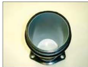
パッキン装着完了
